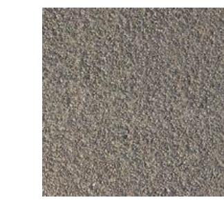
Wassergebundene Decke mit Natursteinen
